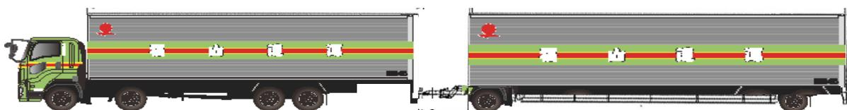
従来の 21mフルトレーラより後ろのトレーラが 4m長くなり、容積がさらに 35%上がります。
