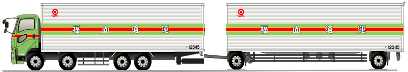
25mダブル連結トラック 車両全長 25.0m
